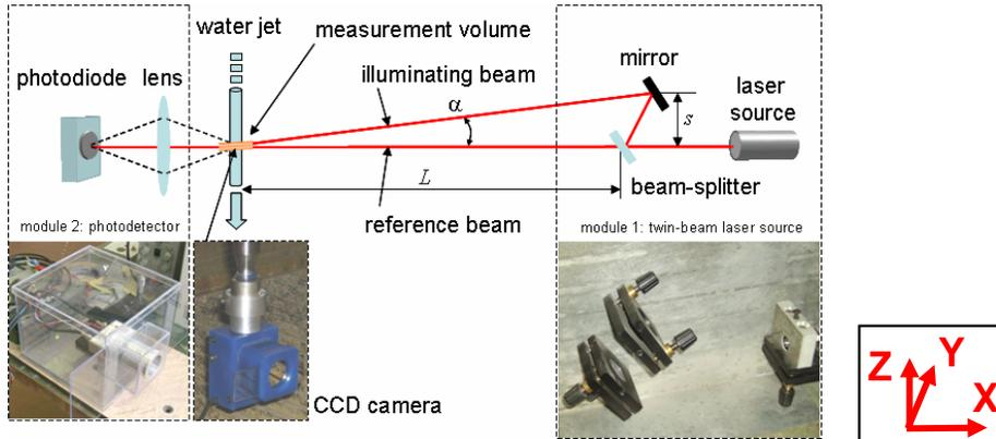
**Figure 1.** Laser Doppler dual-incident-beam velocimeter developed at the Water jet lab of the Dipartimento di Meccanica of the Politecnico di Milano.
